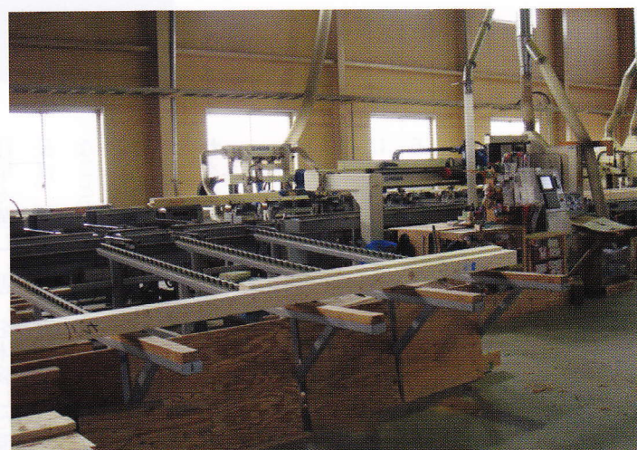
プレカット第3工場 柱加工機
